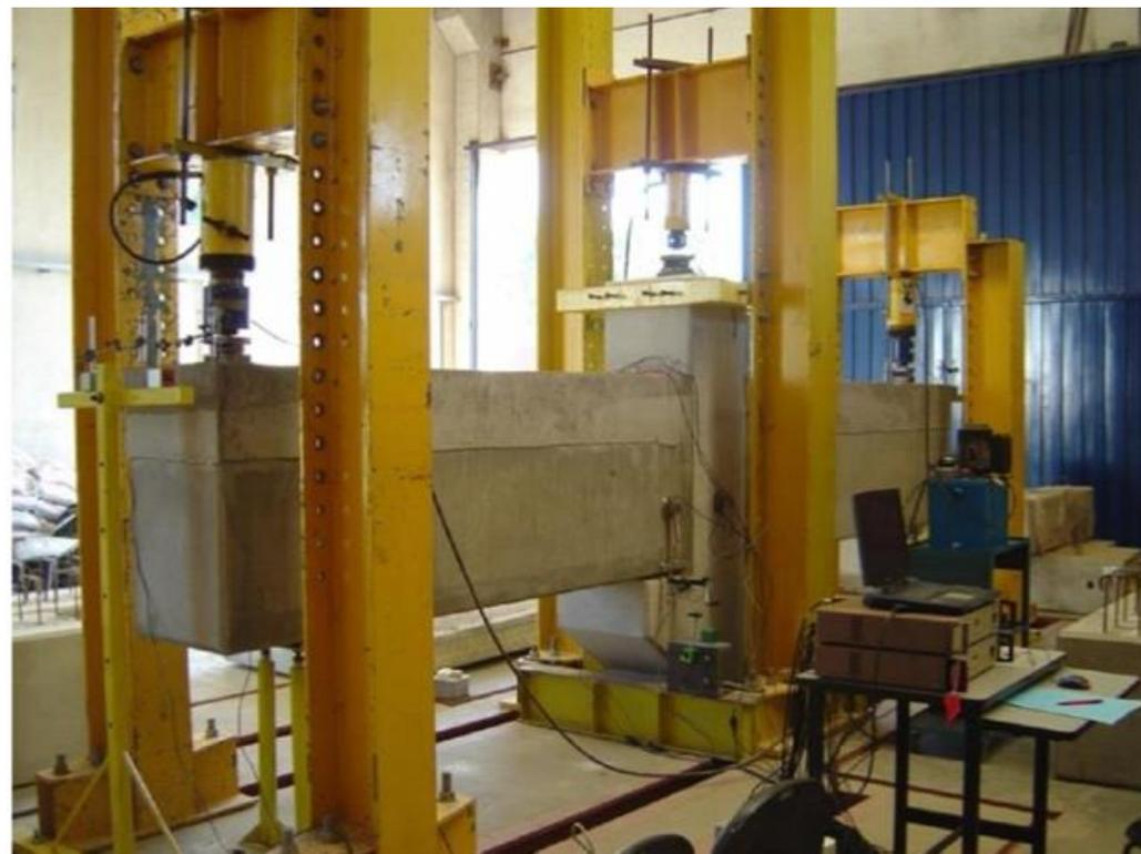
Sérgio Azevedo Coelho. Avaliação da rigidez de uma ligação viga-pilar resistente a momento fletor negativo empregada em estruturas pré moldadas: Análise via modelagem computacional. 2019. Dissertação (Mestrado) - UFG
